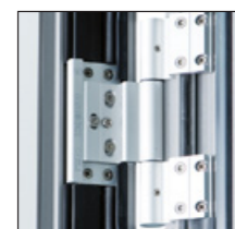
Paumelle 150 kg, réglage tridimensionnel (en hauteur, latéralement et en compression)
