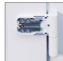
Paumelle 120 kg, réglage tridimensionnel (en hauteur, latéralement et en compression)
